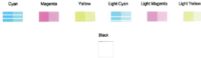
Şekil 9-2 Hatalı renk bloklarına örnekler
